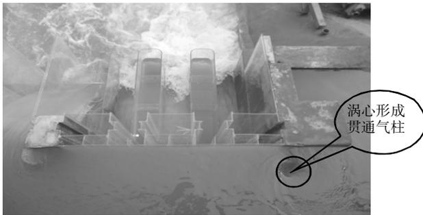
图3 校核水位底孔整体泄流时的进口流态
