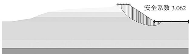
图9 无耦合下围堰边坡稳定分析
