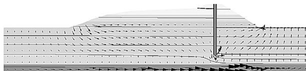
图11 防渗加固后渗流计算结果
