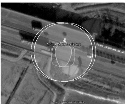
图 6 蒸气云爆炸冲击波区域图
